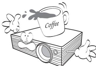
11. Évitez de placer des objets devant la lentille de projection lorsque le projecteur est en cours d'utilisation car ils risqueraient de se déformer en raison de la chaleur ou de provoquer un incendie. Pour éteindre la lampe temporairement, appuyez sur le bouton **Blank** (Vierge) du projecteur ou de la télécommande.
